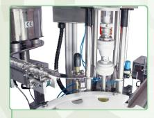
旋蓋位置上設計有瓶子固定裝置,且旋蓋 頭設計有扭力調整裝置,可依不同需求白 由調整瓶蓋緊實度;旋蓋頭可依瓶蓋尺寸 不同,輕易的進行更換。
