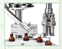
封蓋頭設計為四片滾刀,並可自由調整 封蓋緊實度,瓶蓋美觀不易受損,可依 瓶蓋尺寸不同,輕易的進行更換封蓋頭 , 滿足客戶不同需求。
